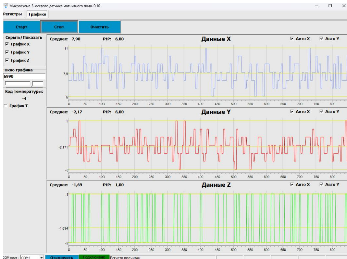
Внешний вид программы конфигурации микросхемы, в режиме потокового сбора данных с XYZ каналов.
